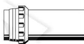
Für stark beanspruchte Rohrleitungen mit geringer Wandstärke wird der Einsatz von Einstekhhülsen empfohlen.
