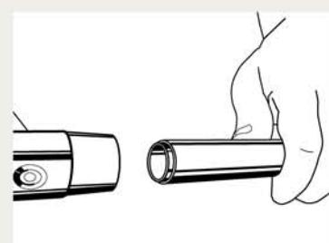
**5.** Hülse muß mit Rohrende bündig abschließen.
